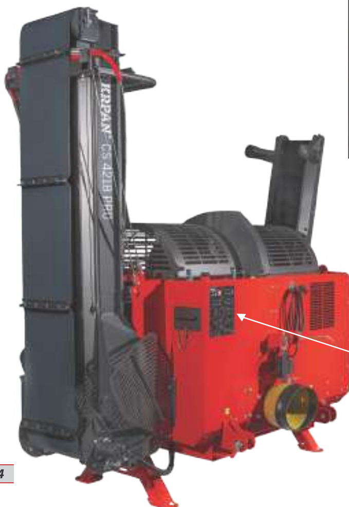
KR PAN CS 4218 PRO joystick-kal működtethető: minden funkció elektro-hidraulikusan működik, kivéve a hasítás hosszának szakaszolása
