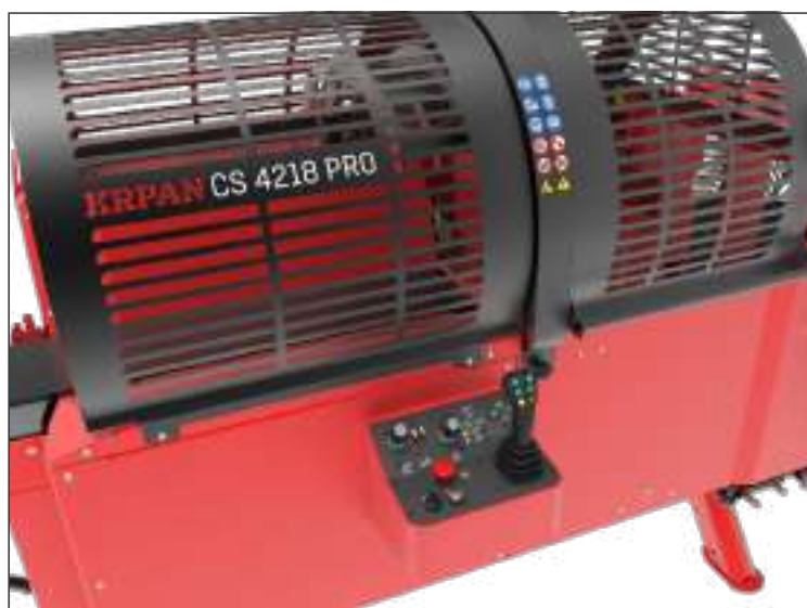
KR PAN CS 4218 PRO joystick-kal működtethető: minden funkció elektro-hidraulikusan működik, kivéve a hasítás hosszának szakaszolása
